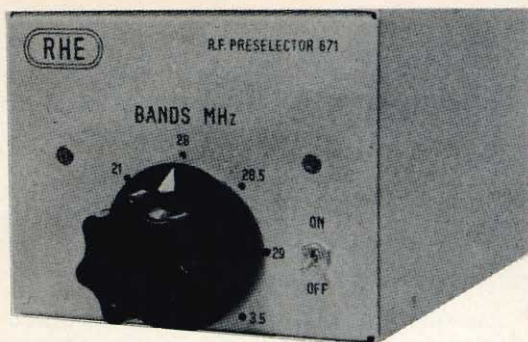
Fig. 8 - Preselector 671 - convertitore per 7, 14, 21 e 28 MHz con transistor FET. Uscita 3,5 - 4 MHz.
