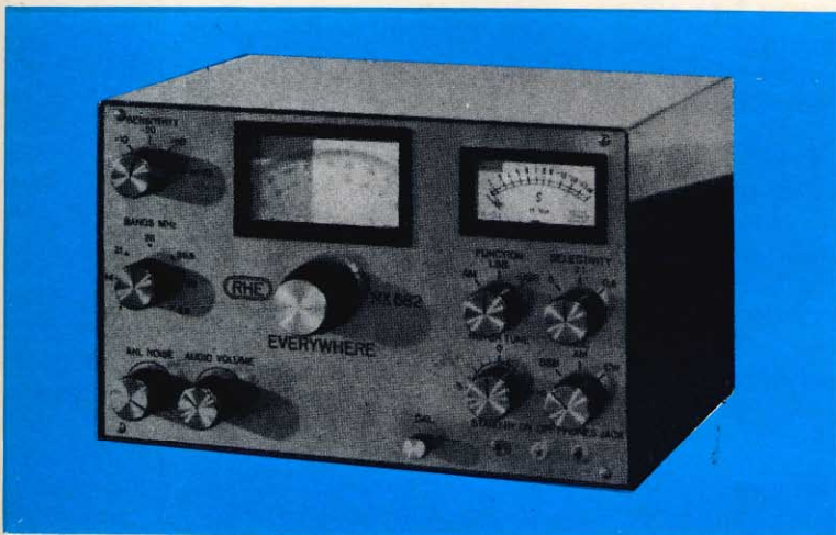
Fig. 7 - Ricevitore per gamme radiometriche RX - 682 - Everywhere, completamente transistorizzato.
